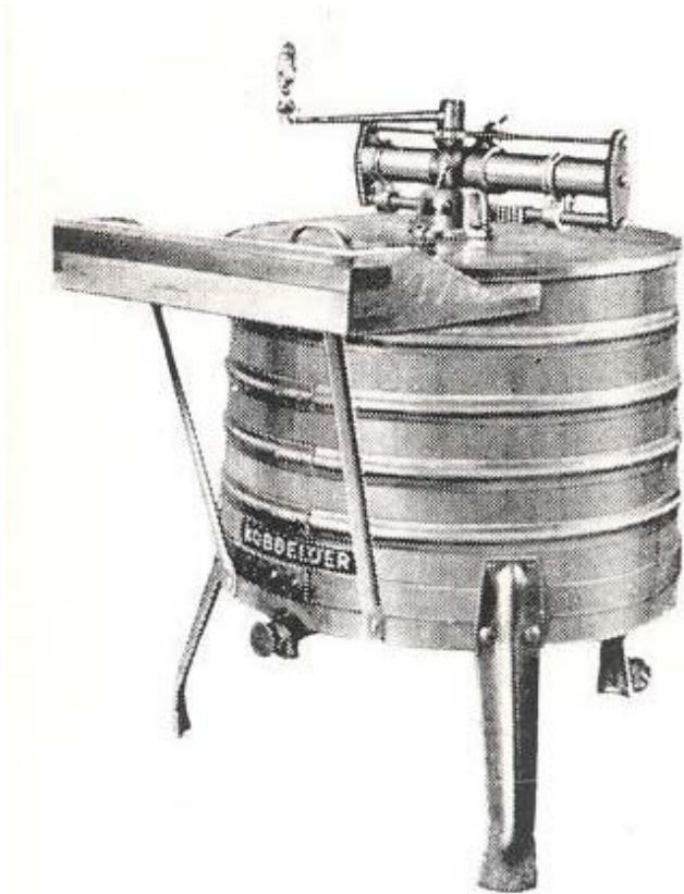
Holzbottich-Waschmaschine mit Wassermotor 1950
